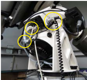
Gesicherte Verkabelung an einer AstroPhysics-Montierung. Mitte: Detailansicht der zusammengeführten Kabel RS-232, Guiding und Strom sowie der Zugentlastung am Stecker des Handcontrollers. Rechts: Detailansicht der Zugentlastung des sehr schweren Spiralkabels der Handsteuerung am Stecker des RA-Motorkabels.
