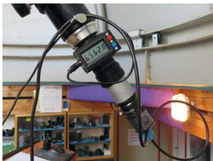
Kabelsicherung an einem H-alpha-Filter: Geschlaufte, zugentlastete Kabel für USB 3.0 und Spannungsversorgung, befestigt an der Klemmschraube des Okularauszugs
