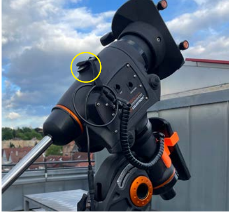
Zugentlastung für das Stromkabel, das mit Klettband an der Montierung hochgebunden wird. Das vermeidet auch Kontaktverluste durch Wackelkontakte.
