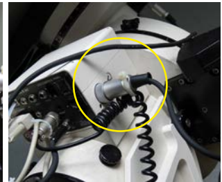
Gesicherte Verkabelung an einer AstroPhysics-Montierung. Mitte: Detailansicht der zusammengeführten Kabel RS-232, Guiding und Strom sowie der Zugentlastung am Stecker des Handcontrollers. Rechts: Detailansicht der Zugentlastung des sehr schweren Spiralkabels der Handsteuerung am Stecker des RA-Motorkabels.
