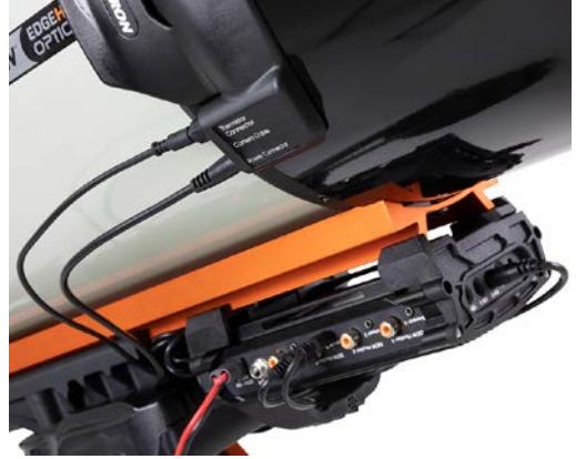
Kurze Kabel an einem festen Verteiler, hier der Celestron Tauschutzsteuerung mit integrierter Stromverteilung für weitere Geräte.
